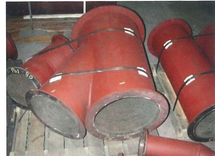
**Nahlose** Rohre bis **3 m Länge** und **600 mm Innendurchmesser**,
